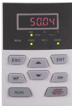
Рис. 4-7. Режим прямого изменения частоты
